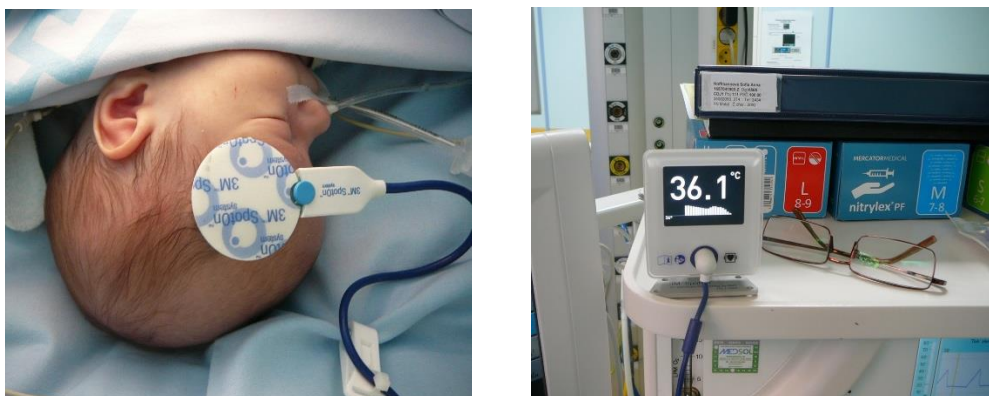
Obrázek 3 Teploměr SpotOn 3M; neinvazivní kontinuální měření teploty jádra pomocí isotermického kanálu do nitra mozku pacienta
